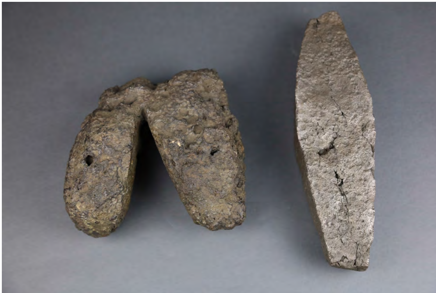
Fig. 4 Lupă și lingou bipyramidal din fier (Grădiștea de Munte - Sarmizegetusa Regia) Bloom and bipyramidal iron ingot (Grădiștea de Munte - Sarmizegetusa Regia)
