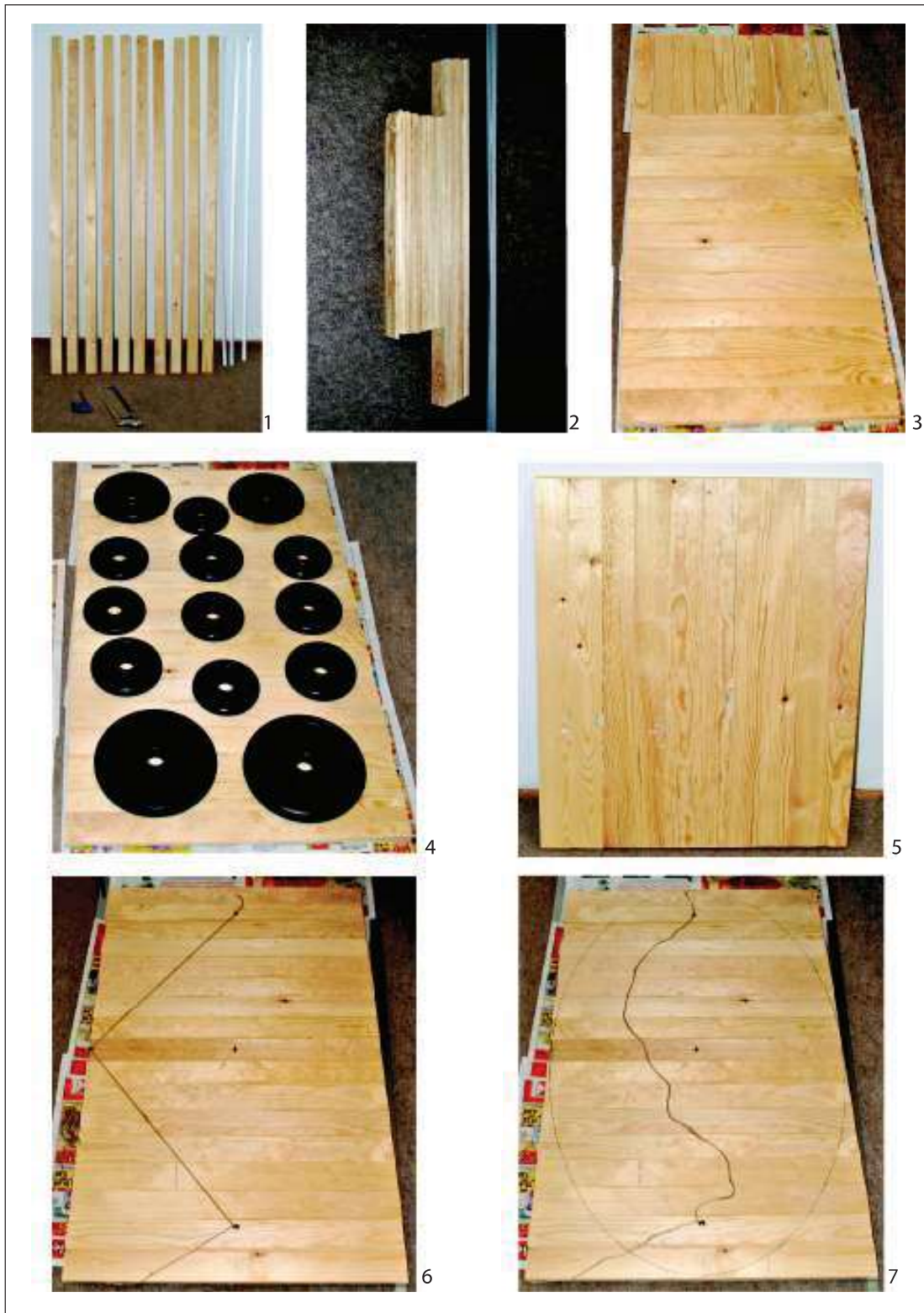
Planșa XXXVIII. Etape din procesul de fabricare a unui scut. Realizarea placajului și trasarea formei generale.
